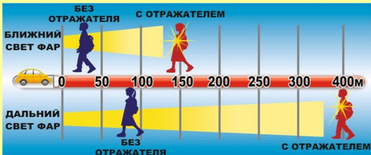
Световозвращающие при способления (катафоты, фликеры) –это элементы пассивной безопасности. Они снижают риск наезда на пешехода в темное время суток в 5-6 раз, так как изготовлены из специальной пленки и очень ярко отражают свет фор. Они хорошо видны водителям.
